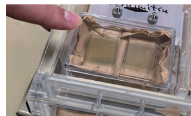
金蒸着した2枚の鏡 (透けて見えるほど薄く蒸着している。)
