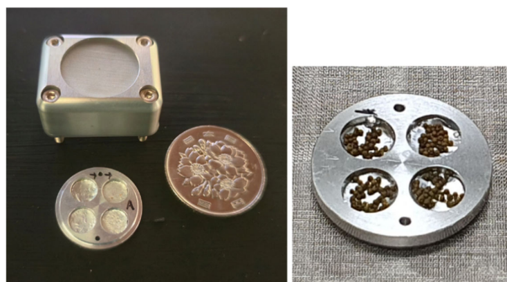
図 3. 左：「たんぽぽ」実験で使用された宇宙曝露ユニット（上）と、その内部に搭載されるサンプル基板（下）。大きさの比較のために 100 円硬貨を配置している。右：サンプル基板に乾燥させた成熟孢子体サンプルを 30 個ずつ四つの穴に配置した様子。
