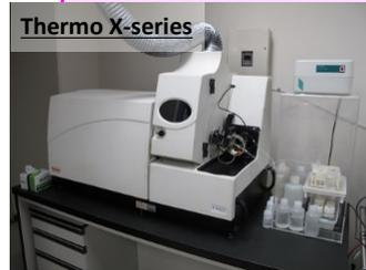
誘導結合プラズマ質量分析装置 (ICP-MS) ¥2,000/sample<sup>D</sup>
