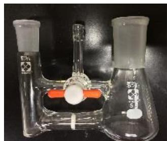
原材料費（三角フラスコとジョイント15/25メスは依頼者が持参した物のため、金額が発生するのは三方テフロンコック（ゴム止めφ8mm付き）とガラスフィルターを間に入れたガラス管に酸素やガス等となる）
