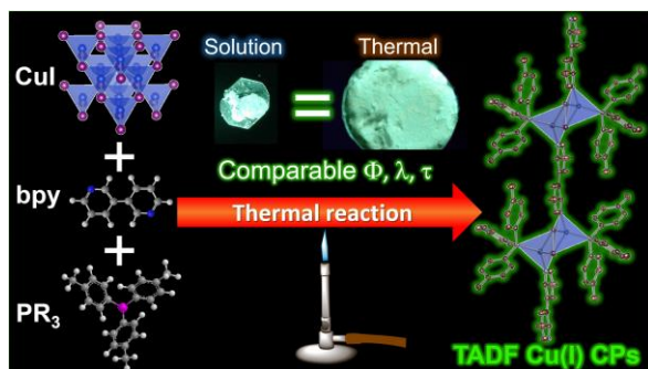
図3. 強発光性銅(I)錯体の完全無溶媒加熱合成
