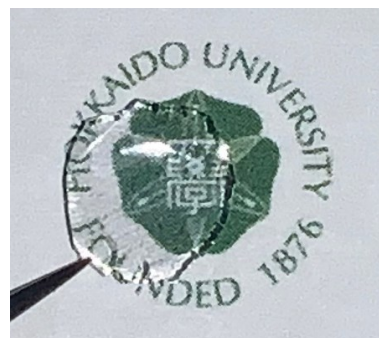
柔粘性/強誘電性イオン結晶粉末を加圧して得られた透明多結晶フィルム。
