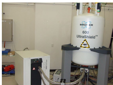
図 1. クライオプローブ装着 600MHz NMR
