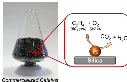
図2 シリカ担持白金ナノ粒子によるエチレンの低温酸化除去
