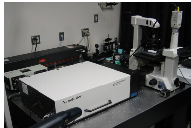
Fig. 2. 3次元空間分解顕微分光 (蛍光・ラマン) 分光システム
