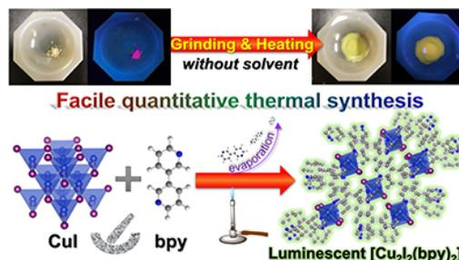
図2. 無溶媒・固相反応で容易に合成可能な強発光性 Cu(I)錯体
