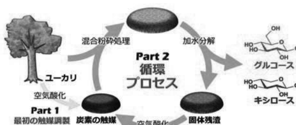
図1 ユーカリを利用した循環型糖化プロセス
