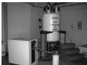
図 1. クライオプローブ装着 600MHz NMR
